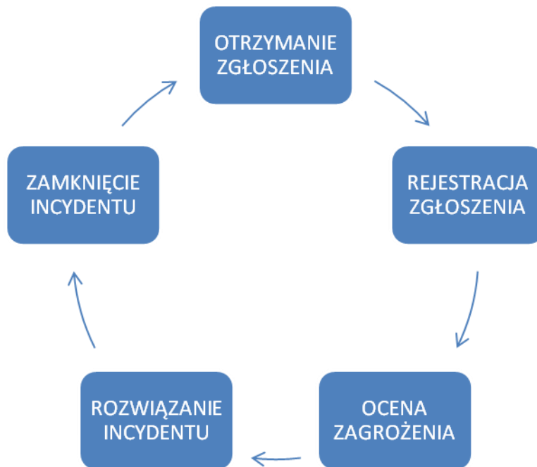
Rys. 15. Fazy obsługi incydentu naruszającego bezpieczeństwo teleinformatyczne.
