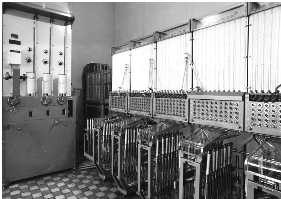
Rys. 4.2. Urządzenia (maszyny analogowe) stosowane do rozwiązań w modelowaniu ujęć wód podziemnych i obliczaniu ich zasobów eksploatacyjnych w latach 60. i 70. XX w. Widok ogólny integratora hydraulicznego (AGH Kraków, fot. J. Leśniak)
