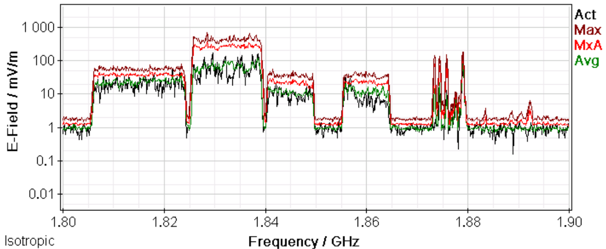
Rys. 11 Wyniki pomiarów selektywnych – zakres częstotliwości: 1805,1 MHz – 1879,9 MHz
