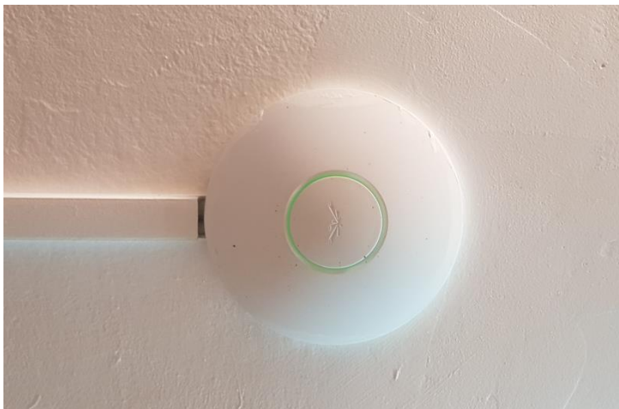
Fot. 2: Widok punktu dostępowego model UniFi UAP
