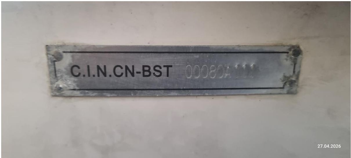
Foto nr 15 Łódź ŁM OIRM – 17 tabliczka znamionowa - numer przypisany łodzi zgodnie z normą CIN w dniu 27.04.2026
