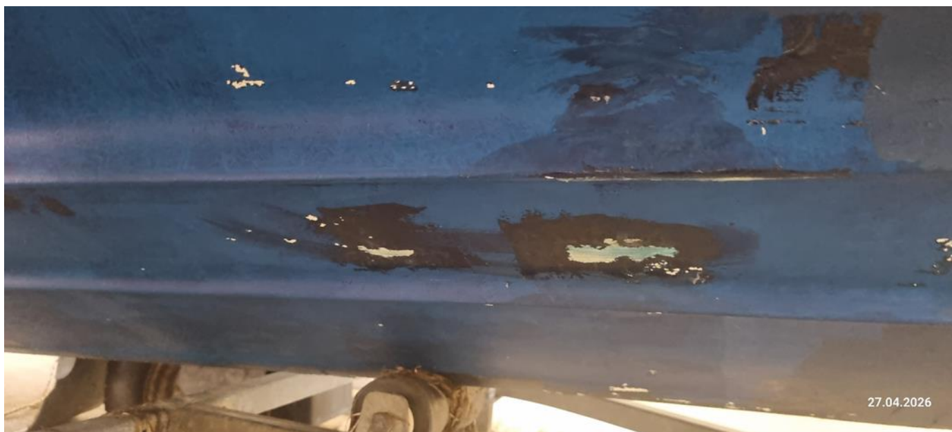
Foto nr 14 Łódź ŁM OIRM – 17 widok uszkodzeń kadłuba w dniu 27.04.2026
