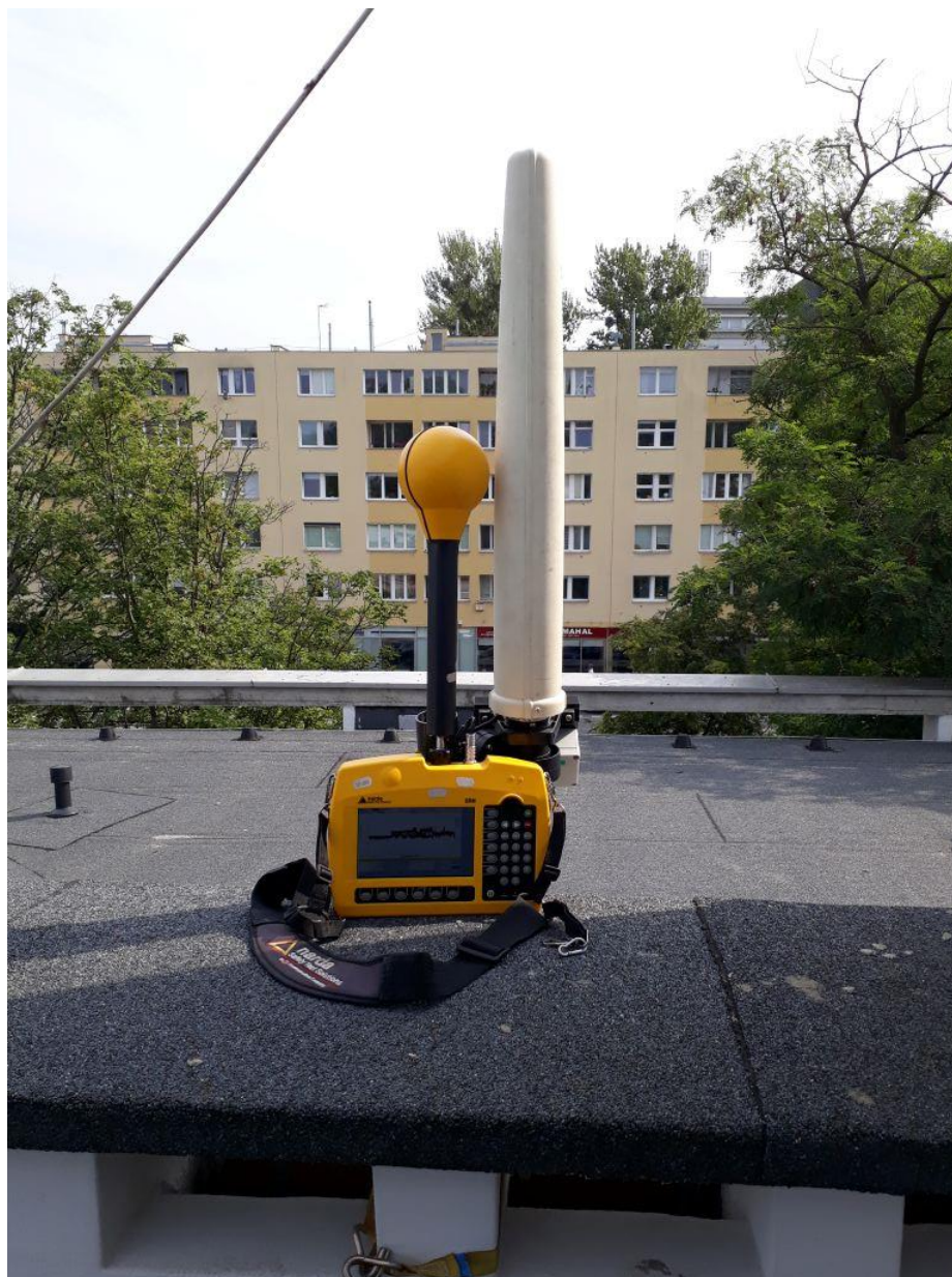
Rys. 8 Zespół Sportowych Szkół Ogólnokształcących – pomiary selektywne SRM-3600
