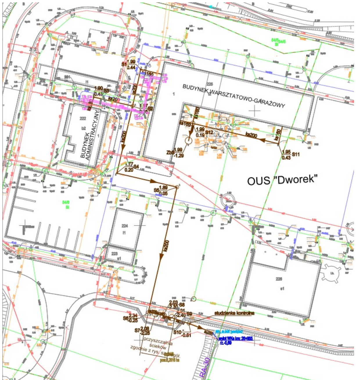
Lokalizacja wylotu ścieków bytowych na terenie OUS do rowu meliracyjnego
