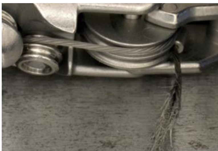
Rysunek C: 20-krotne powiększenie zerwanej linki chwytającej w narzędziu da Vinci Xi
