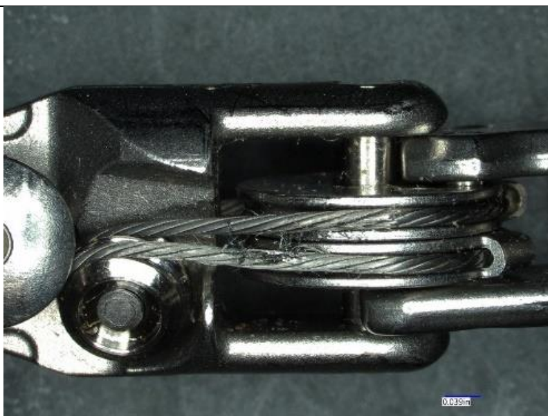
Rysunek D: 20-krotne powiększenie wystrzępionej linki chwytającej w narzędziu da Vinci Xi
