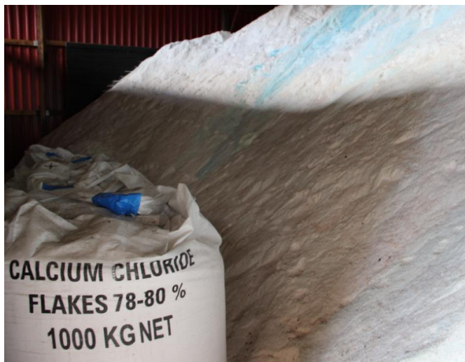
Fot. 1 i 2 Po lewej zbiornik do składowania roztworu chlorku sodu lub wapnia nazywanej powszechnie „solanką”, po prawej – magazyn materiałów do zapobiegania śliskości (chlorek wapnia składowany w workach typu „big bag” oraz dalej po prawej chlorek sodu składowany w stanie luźnym w przyzmach).
