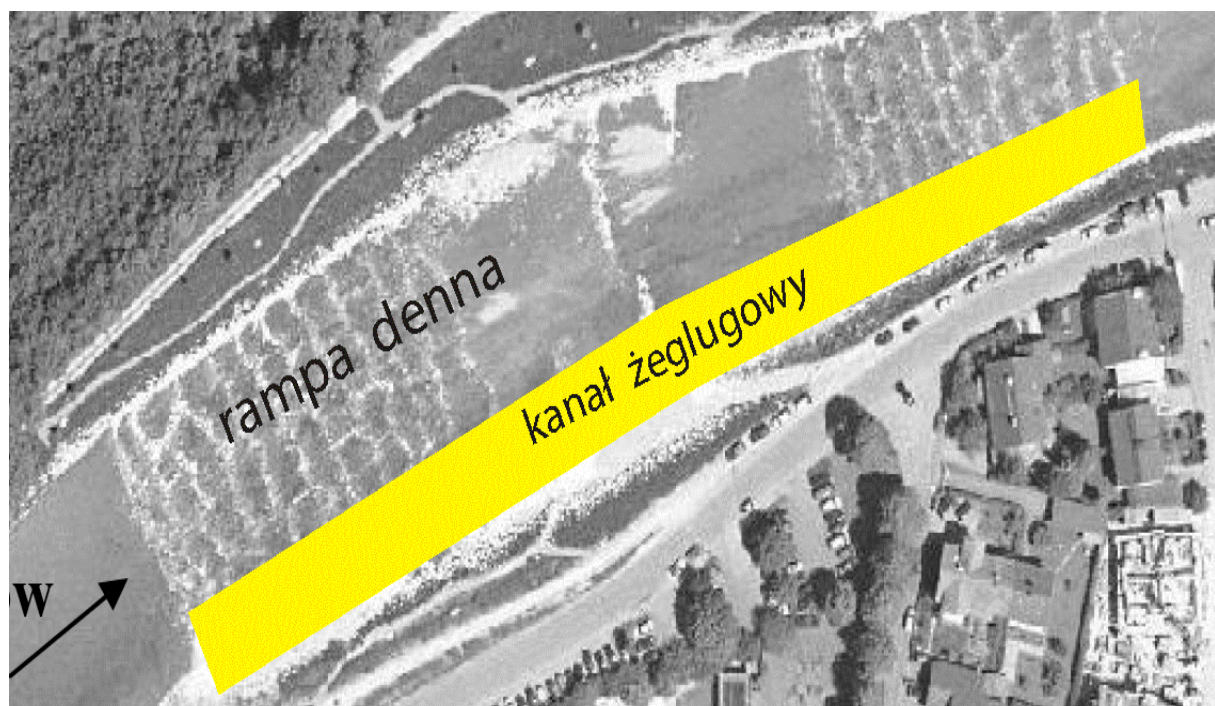
Rys. 8. Rampa denna. Rozwiązanie z Kolbermoor, rzeka Mangfall, Q=39 \text{ m}^3/\text{s}
