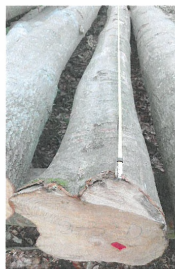
Ryc. 9. Pomiar długości sztuki drewna z pominięciem rżnia podcinającego
