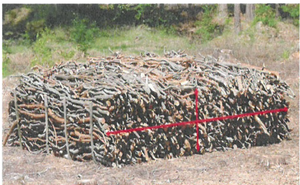
Ryc. 17. Pomiar przeciętnej szerokości i wysokości w stosie drewna zabezpieczonym palikami, wyrabianego samowYROBEM
