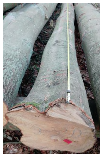
Ryc. 9. Pomiar długości sztuki drewna z pominięciem rżazu podcinającego
