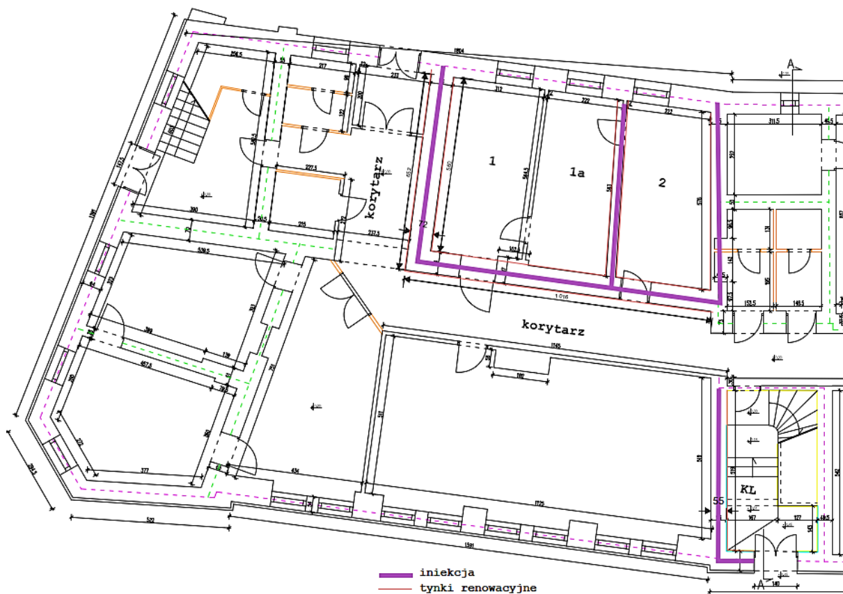
Rysunek 1 Zakres iniekcji krystalicznej od wewnątrz budynku PUW w Przemyślu.
