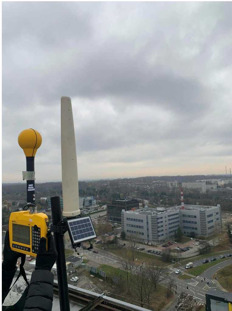
Rys. 12 Urząd Miasta Katowice – pomiary selektywne SRM-3600
