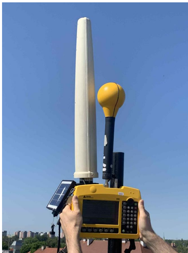
Rys. 8 Budynek, ul. Batorego 34 – pomiary selektywne SRM-3600
