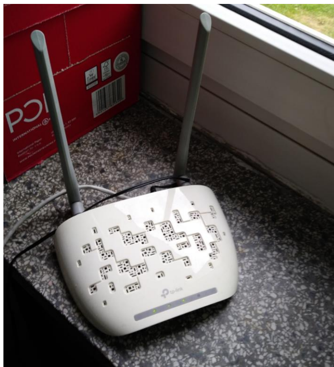
Fot. 3: Zdjęcie punktu dostępowego model TL-WA801ND
