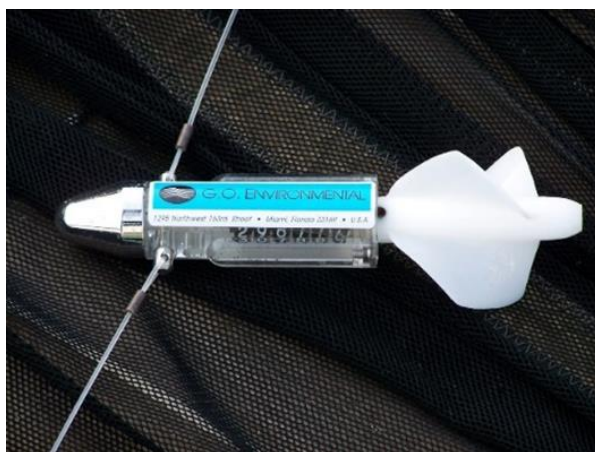
Fot. 2.2.4.1. Licznik przebytej przez siatkę połowową drogi (tzw. flowmeter). Wartość ta w połączeniu z informacją o powierzchni wlotu siatki połowowej, pozwala na obliczenie objętości przefiltrowanej wody, a tym samym, na standaryzację wyników (w tym raporcie: liczba os. w 100\ m^3 wody).
