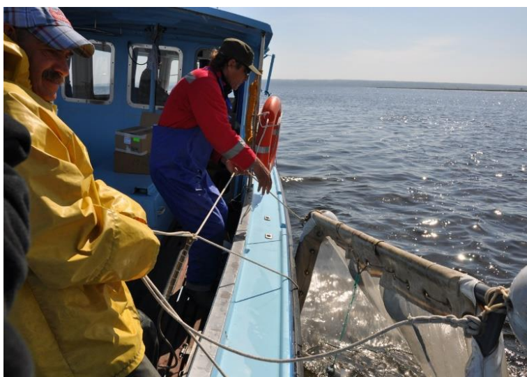
Fot. 2.2.2.1. Jednostka MIR-2 oraz wydawanie z jej pokładu siatki neustonowej, służącej do połowu larw oraz wczesnego narybku (Fot. D. Fey).
