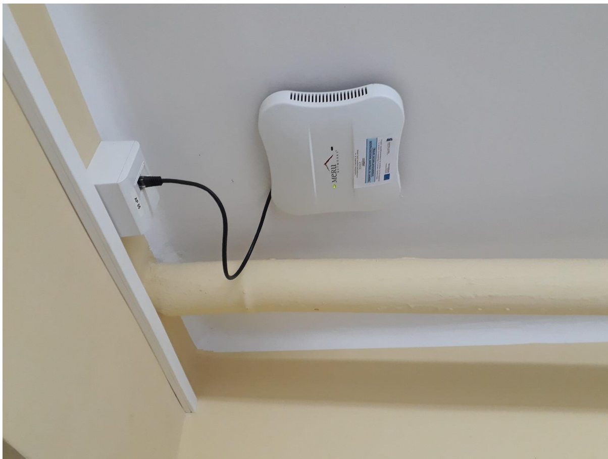
Fot. 1: Zdjęcie punktu dostępowego model AP-1000
