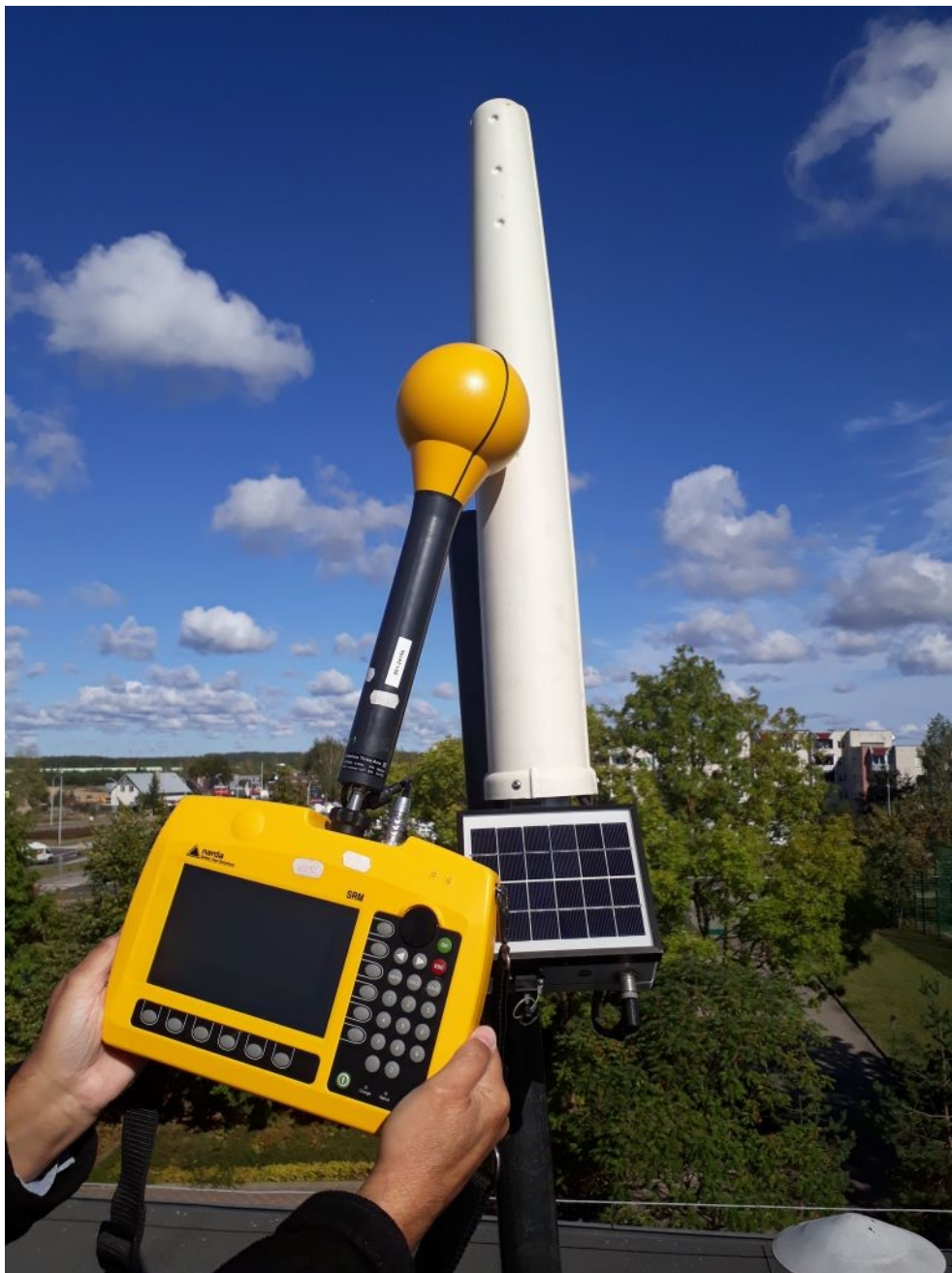
Rys. 9 DPS w Suwałkach – pomiary selektywne SRM-3600
