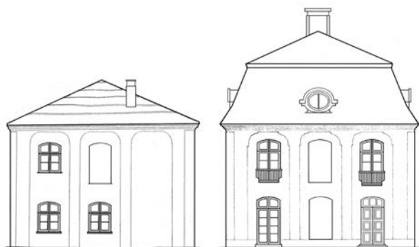
12. Pawilon wschodni – elewacja północna na osi alei lipowych okalających salon ogrodowy. Stan obecny i rekonstrukcja stanu z XVIII w. Oprac. A. Dąbrowska East Pavilion – northern façade along the axis of the lime tree avenues surrounding the garden parlour. Present condition and reconstruction of its 18th-century appearance, by A. Dąbrowska
