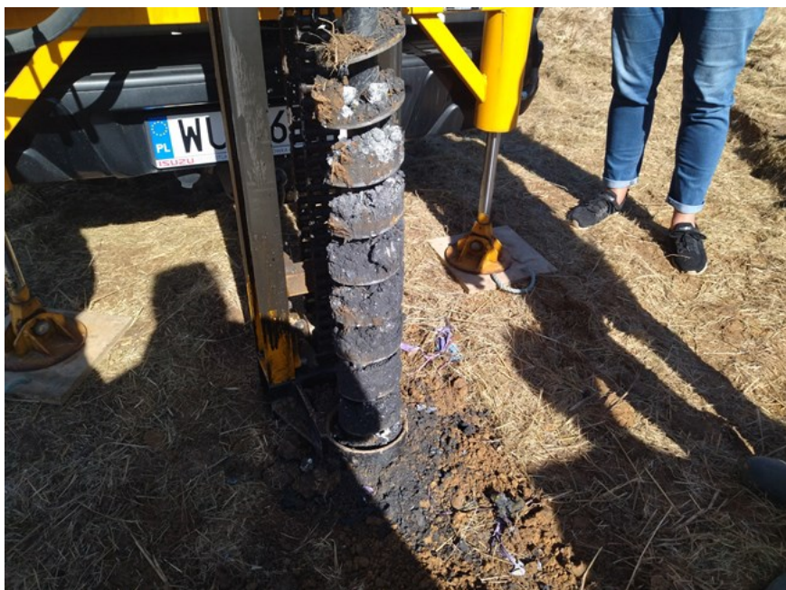
Zdjęcie 17. Wykorzystanie wiertni w celu wykrycia nielegalnego deponowania odpadów
