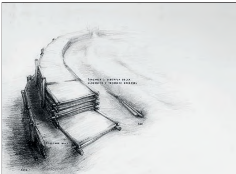
Ryc. 6. Wizualizacja konstrukcji skrzyniowej wału zewnętrznego grodziska w Chodliku, rys. K. Bijak.
