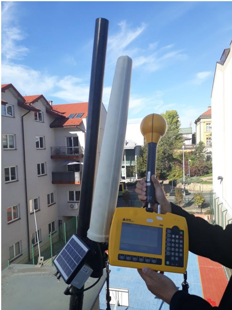
Rys. 10 3 LO w Tarnowie – pomiary selektywne SRM-3600
