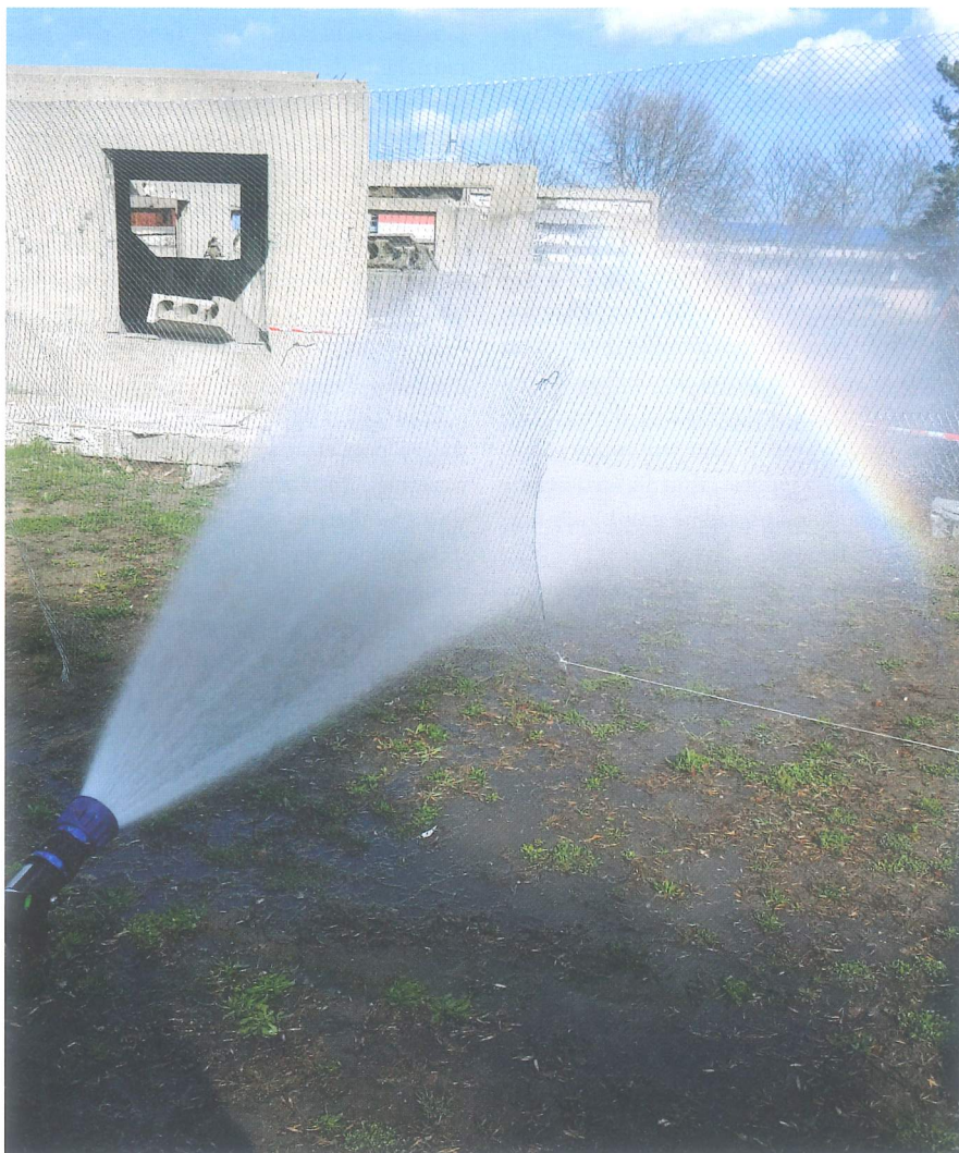
Podawanie prądu gaśniczego na odizolowany od ziemi element pod napięciem
