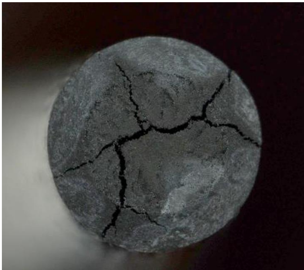
Ilustracja 1: Pęknięcie pręta łączącego Hoffmann® II z włókna węglowego
