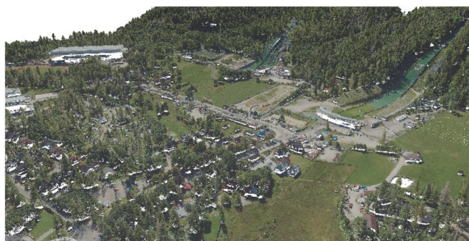
Rys. 3. Chmura punktów ALS dla fragmentu Zakopanego
