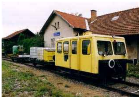
Fot. 31 Zbiorniki ze środkami chemicznymi zamontowane na platformie kolejowej Źródło: http://members.nanet.at/jirout/noe_landesbahnen.html
