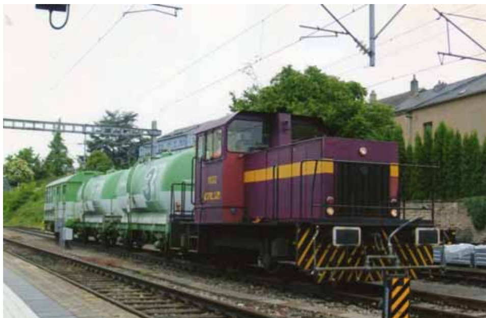
Fot. 13 Pociąg specjalny do chemicznego odchwasczania torów Źródło http://rfe.railclub.ru/pix/new/2011/11_nov14-lu1/pix.html
