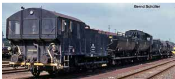
Fot. 16 Pociąg specjalny do chemicznego odchwasczania torów, tabor pochodzi z 1924 roku Źródło: http://www.eisenbahndienstfahrzeuge.de/bdw/884-unkrautspritzzug-db/unkrautsprengzug.htm
