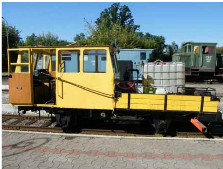
Fot. 25 Zbiorniki ze środkami chemicznymi zamontowane na platformie kolejowej źródło: http://750mm.pl/index.php?topic=2486.0
