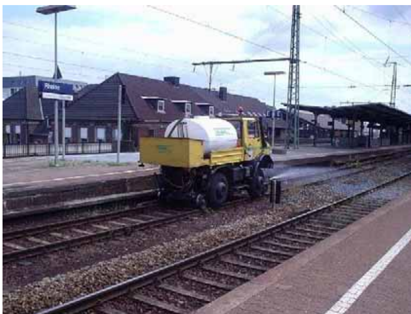
Fot. 22 Ciężarówka dwu-systemowa firmy Mercedes-Benz typu UNIMOG z zamontowaną cysterną ze środkiem chemicznym, Opryski wykonywane w rejonie Nadrenii w Niemczech Źródło: http://www.moebahn.de/t5f4-Sommerferien-in-Rheine.html
