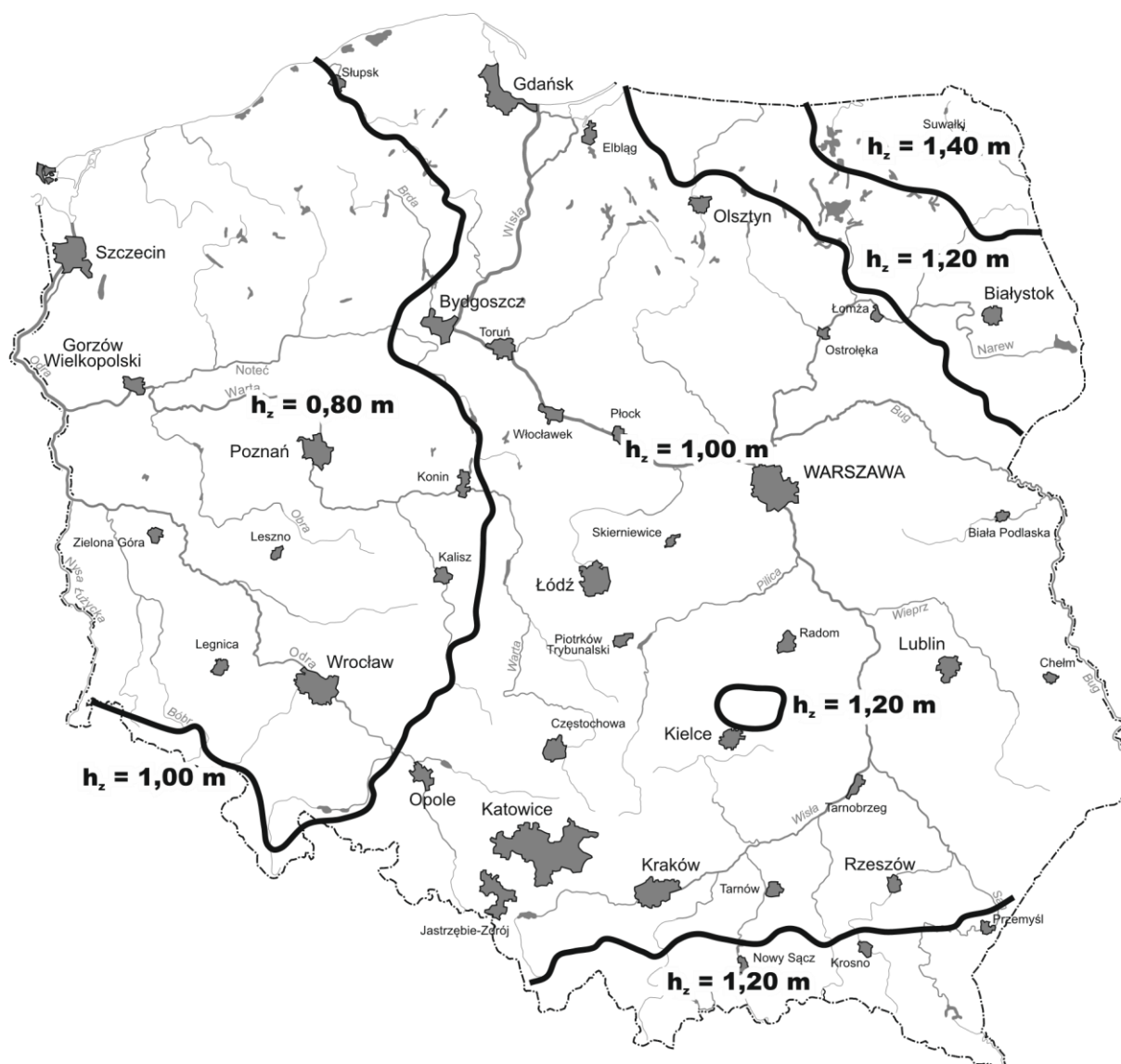
Rys. 10.1. Głębokość przemarzania gruntu h_z wg PN-81/B-03020
