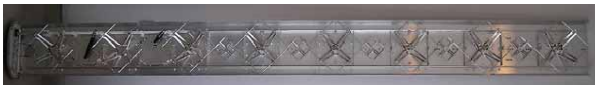
Ryc. 2.3. Wnętrze anteny sektorowej telefonii komórkowej GSM 900 i GSM 1800
