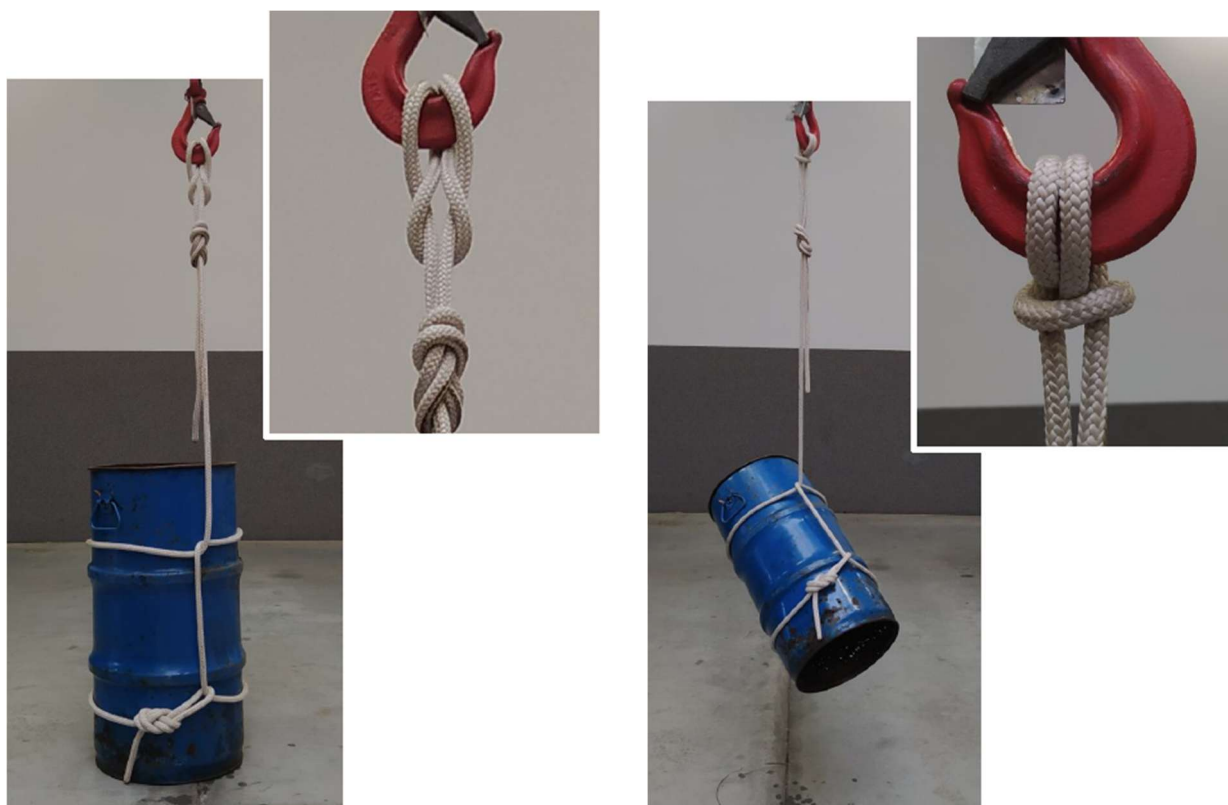
rys. 220 Prezentacja zastosowania zawiesi jedno- lub dwucięgowych
