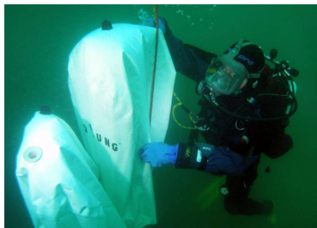
rys. 224 Wydobycie obiektu na powierzchnię wody z zastosowaniem balonów wypornościowych Fot. mł. bryg. Paweł Dyba, SGRW-N „Małopolska”
