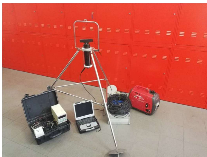
rys. 151 Sonar opuszczany (dookólny) Fot. kpt. Michał Olszewski
