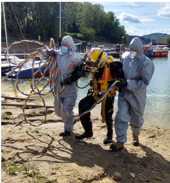
rys. 261 Zasilenie przewodowe nurka w czynnik oddechowy oraz hełm nurkowy do pracy w wodach skażonych
