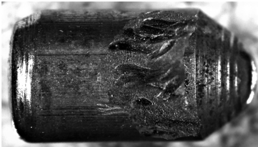
Ryc. 5. Ślad szperaka pozostawiony na popychaczu zapadki zamka. Źródło: materiały Instytutu Ekspertyz Sądowych.
