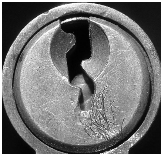
Ryc. 6. Ślad napinacza na elemencie zewnętrznym zamka. Źródło: materiały Instytutu Ekspertyz Sądowych.
