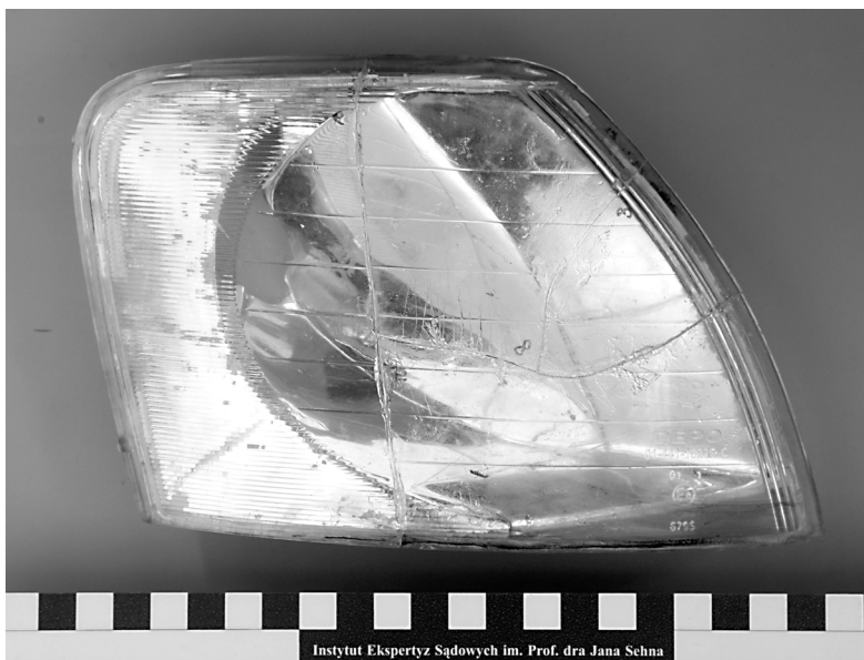
Ryc. 16. Reflektor złożony z przesłanych do badań fragmentów tworzyw sztucznych.
