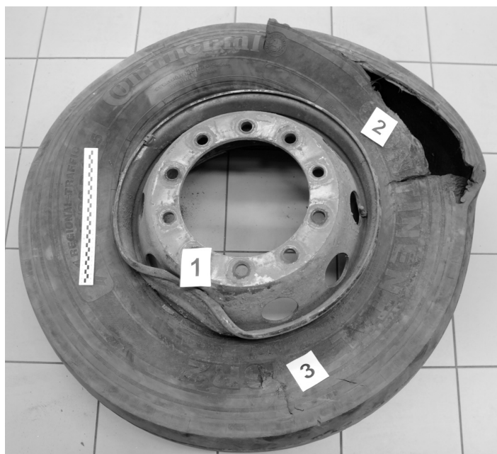
Ryc. 12. Uszkodzenia opony powstałe w wyniku uderzenia opony w inny pojazd.
