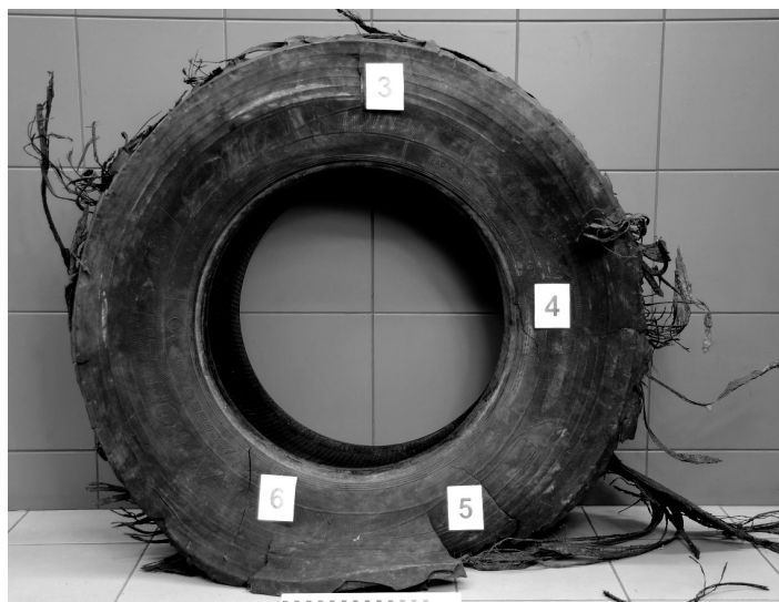
Ryc. 11. Uszkodzenia opony powstałe w wyniku wystrzału opony na skutek nierównomiernego rozkładu ciśnienia.
