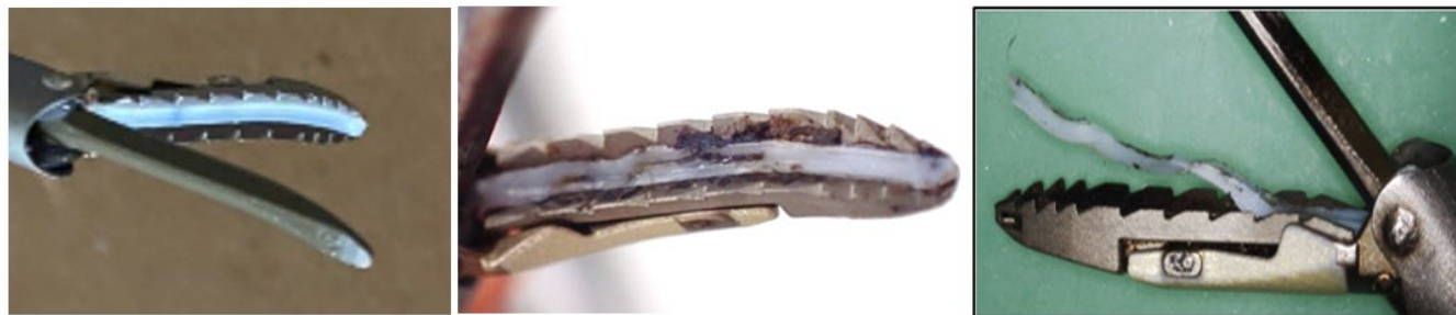
Rysunek 2. Przykład sondy Thunderbeat zgodnej ze specyfikacją (po lewej), z odkształconą podkładką (po prawej), z oddzieloną podkładką (po prawej)
