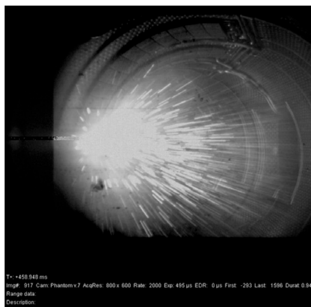
Fot. 5. Zdjęcie z szybkiej kamery obrazujące odpadające elementy komory w wyniku oddziaływania z szybkimi elektronami na Tore Supra, A. Loarte ITER ( https://www.ugent.be/ea/appliedphysics/en/research/fusion/research/data-analysis.htm )
