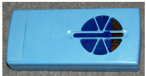
Fot. 5. Dozyometr Radex RD1008 — z lewej zaznaczony środek licznika promieniowania gamma typu Beta-2M, z prawej licznik promieniowania alfa i beta typu Beta-2 z częściowo uchyloną osłoną Photo 5. Radex RD1008 dosimeter — Beta-2M type gamma radiation counter marked on the left, Beta-2 type alpha and beta radiation counter with a partially opened cover on the right
