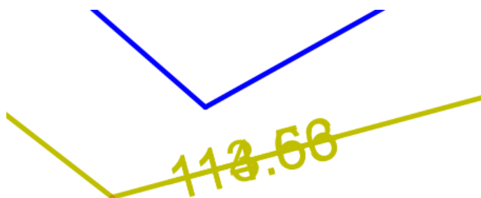
Przykład 1. Wizualizacja rzędnych przewodu w programie QGIS. Wartości rzędnych wyświetlane są jedna na drugiej.
