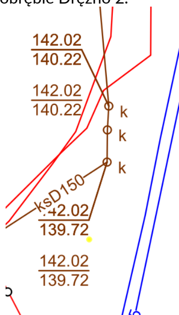
Rysunek. Podgląd wizualizacji rzędnych na studzienkach wymienionych w pozycji 51 i 52 załącznika nr 4.2 w programie QGIS (obręb Drężno).
