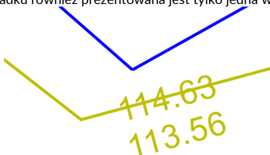
Przykład 2. Wizualizacja rzędnych przewodu w serwisie polska.geoportal2.pl/. Wyświetlane jest wyłącznie wartość atrybutu 'rzedna'. W programach C-GEO i GEO-INFO w takim przypadku również prezentowana jest tylko jedna wartość.
