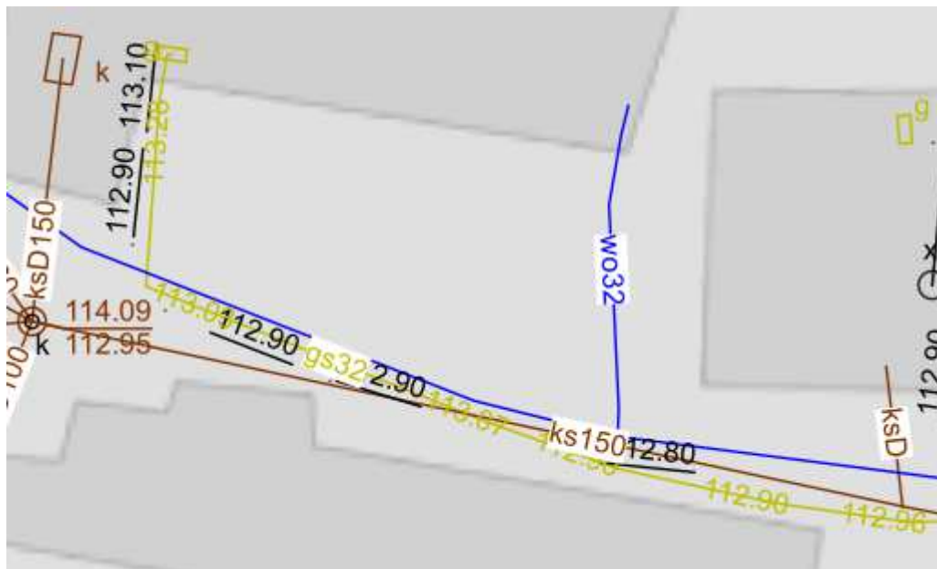
Rysunek. Podgląd wizualizacji rzędnych bez określonej relacji do opisywanego obiektu w programie QGIS (takie same rezultaty otrzymano w serwisie polska.geoportal2.pl i programie C-GEO).
