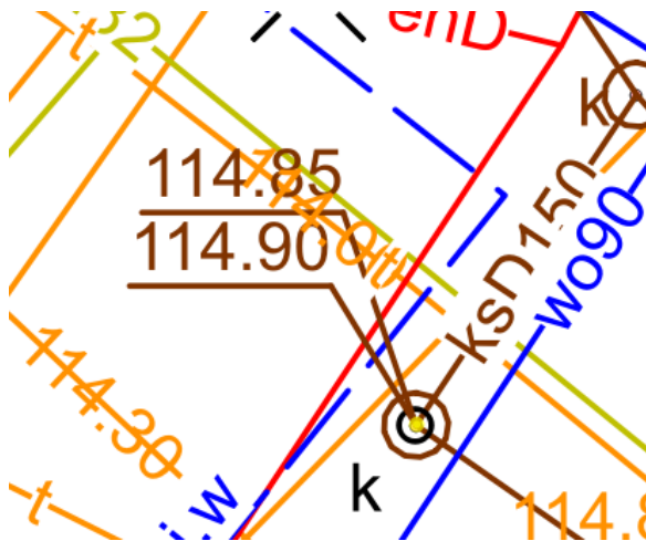
Rysunek. Podgląd wizualizacji dwóch różnych rzędnych góry na jednym włazie w programie QGIS (pozycja 195 załącznika nr 4.2, działka 540/21 w obrębie Barwice 03).
