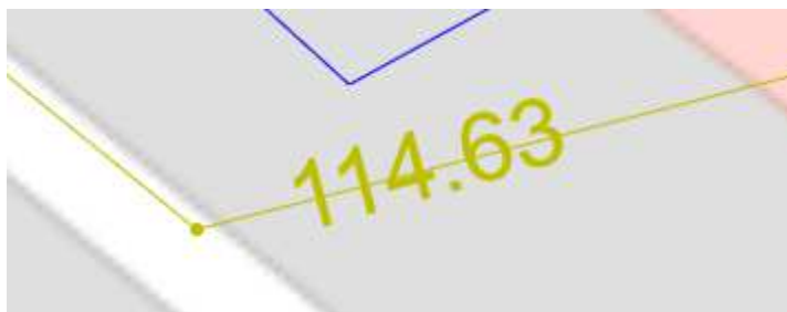
Przykład 2. Wizualizacja rzędnych przewodu w serwisie polska.geoportal2.pl/. Wyświetlane jest wyłącznie wartość atrybutu 'rzedna'. W programach C-GEO i GEO-INFO w takim przypadku również prezentowana jest tylko jedna wartość.
