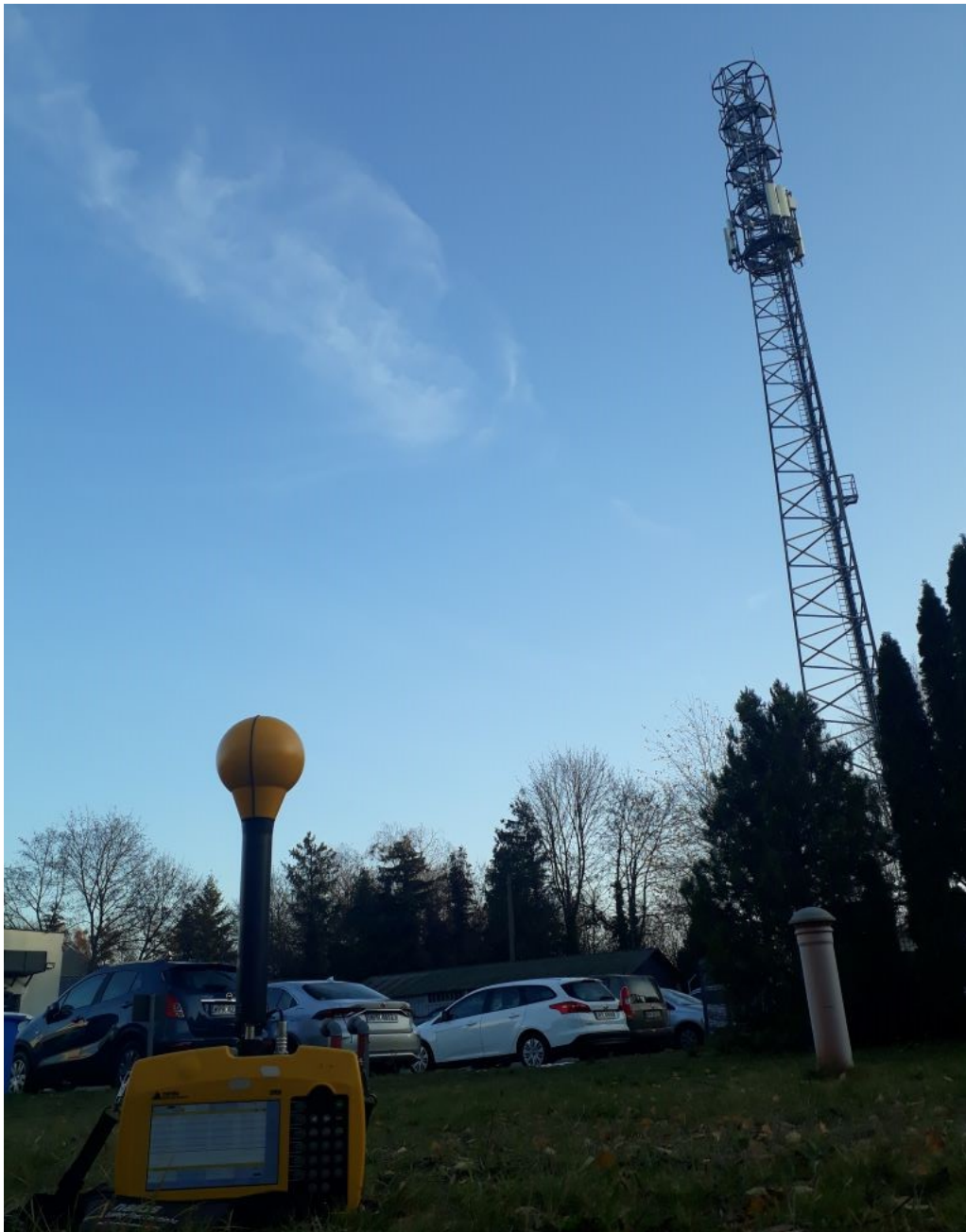
Rys. 9 TBS Pruszków – pomiary selektywne SRM-3600
