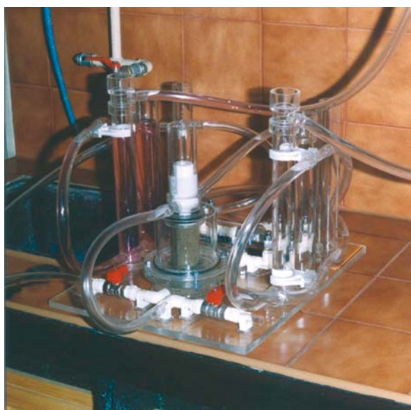
Ryc. 2.15. Sorpcjometr kolumnowy przygotowany do oznaczeń
