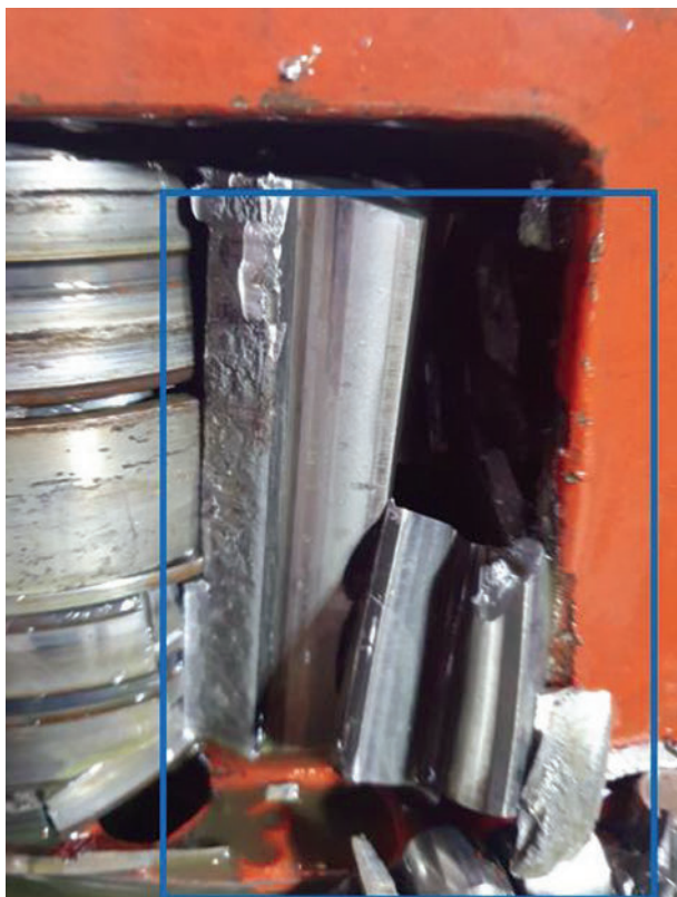
► Rys. 3. Uszkodzone koło obiegowe. Zaawansowany pitting (wżery) na bocznej powierzchni zęba, przechodzący w spalling (tuszczenie) w strefie podziałowej. Widoczne ślady zatarcia adhezyjnego świadczące o przerwaniu filmu olejowego i długotrwałej pracy w warunkach niedostatecznego smarowania
