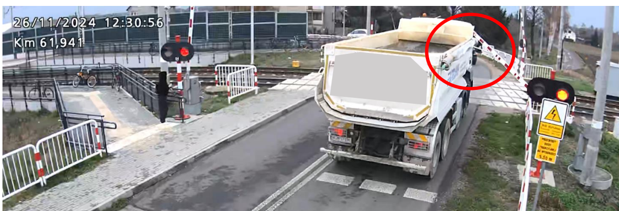
Zdjęcie 8 – Widok z kamery od strony napędu N2 w trakcie wjazdu na przejazd kolejowy samochodu ciężarowego i wygięcie rogatek (źródło: PKP PLK S.A.).
