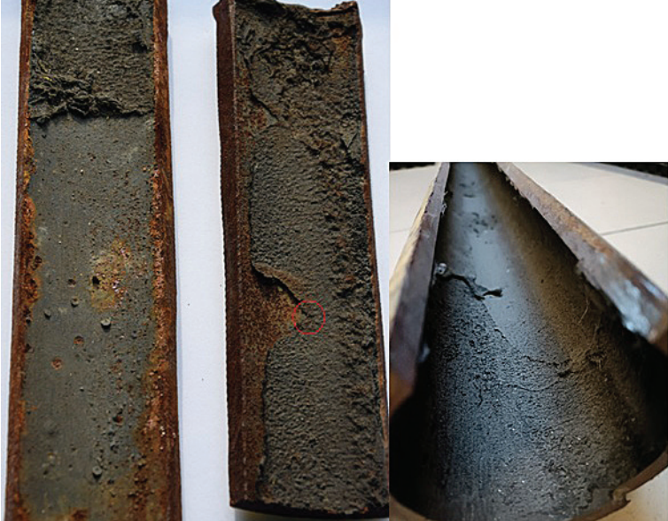
► Rys. 3. Fragment rurociągu pokryty warstwą inhibitora korozji
