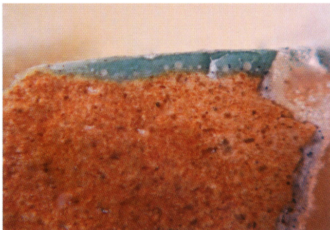
12. Ikonostas – naszlif szkliwa błękitnego. Iconostasis – polished cross-section of blue glaze.
