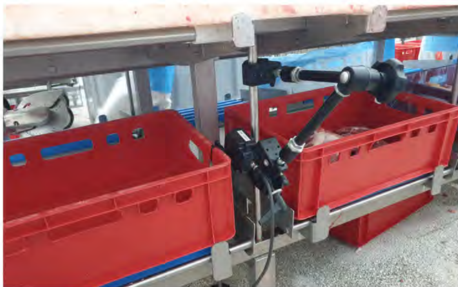
Rysunek 34 Miejsce instalacji anteny RFID przy pojemnikach i znacznik RFID na pojemniku 35
