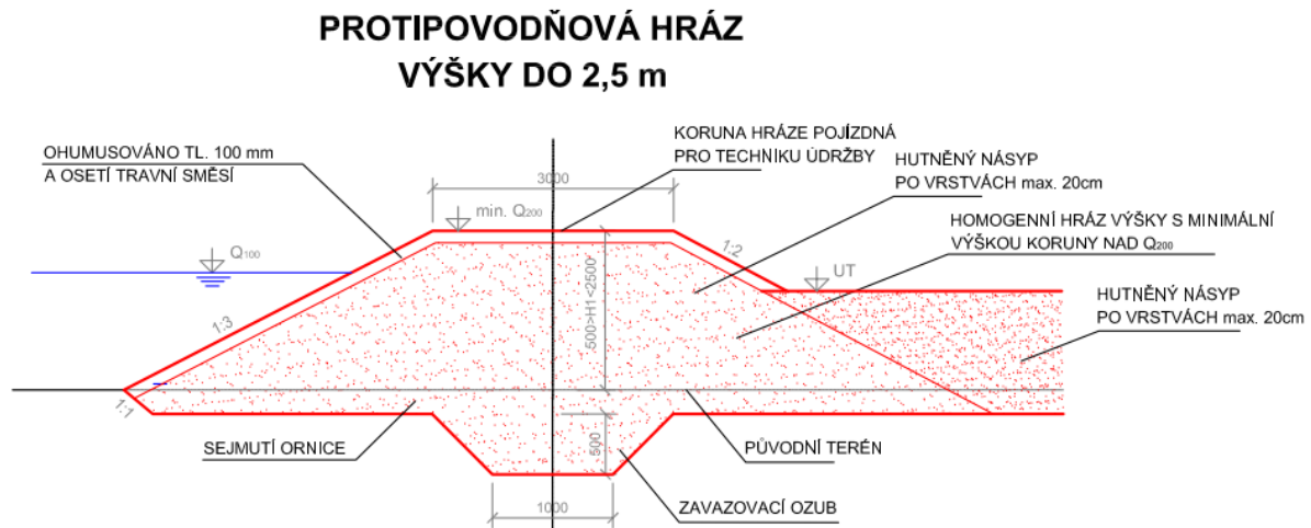
Obrázek 4: Vzorové řezy protipovodňovou hrází
