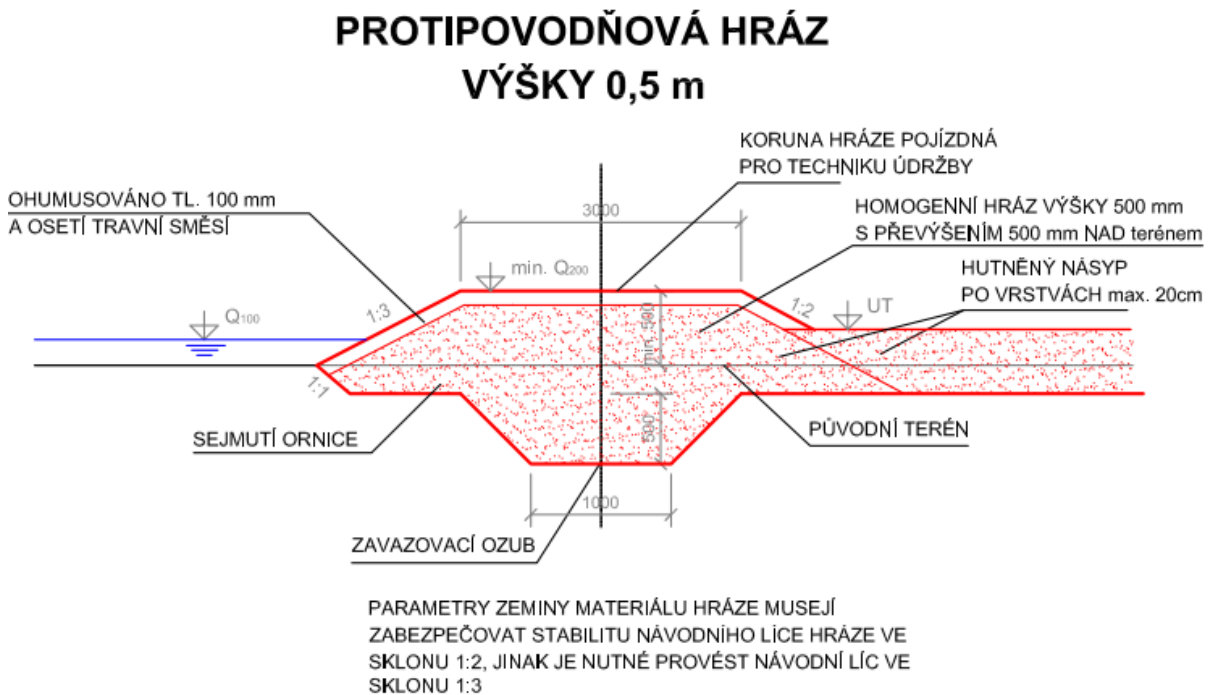
Obrázek 4: Vzorové řezy protipovodňovou hrází
