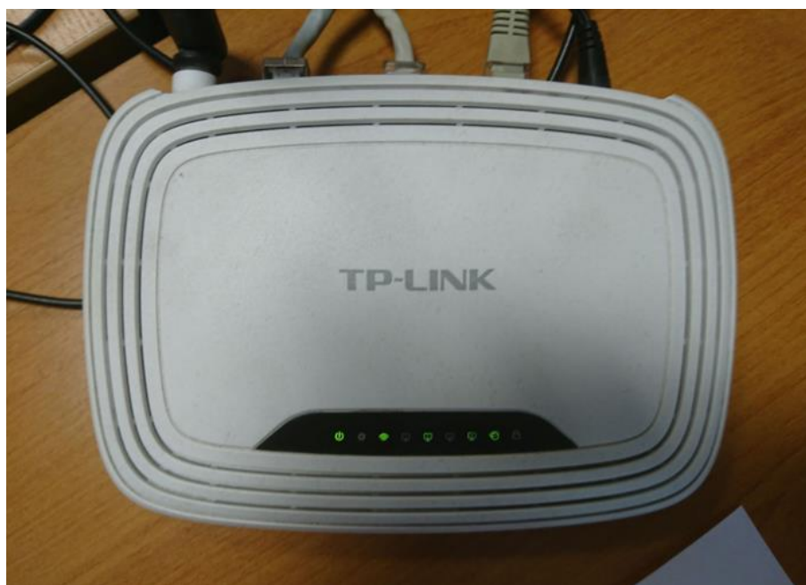
Fot. 6: Widok punktu dostępowego model TL-WR740N
