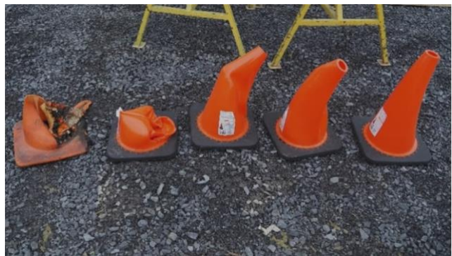
Uszkodzone plastikowe pachotki bezpieczeństwa (od lewej do prawej), które zostały umieszczone w odległości 11, 14, 17, 21 i 24 m.
