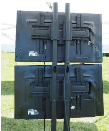
Zdeformowana plastikowa obudowa ekranów wyświetlaczy, które były umieszczone w odległości 30 m.
