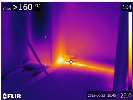
Gorące miejsca w połączeniu czołowym CLT (nieekspozowana strona paneli sufitowych) po 2 godzinach i 50 minutach od rozpoczęcia badania.
