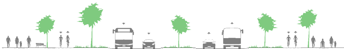
Rys. 15.2.1. Przykładowy przekrój poprzeczny bulwaru
