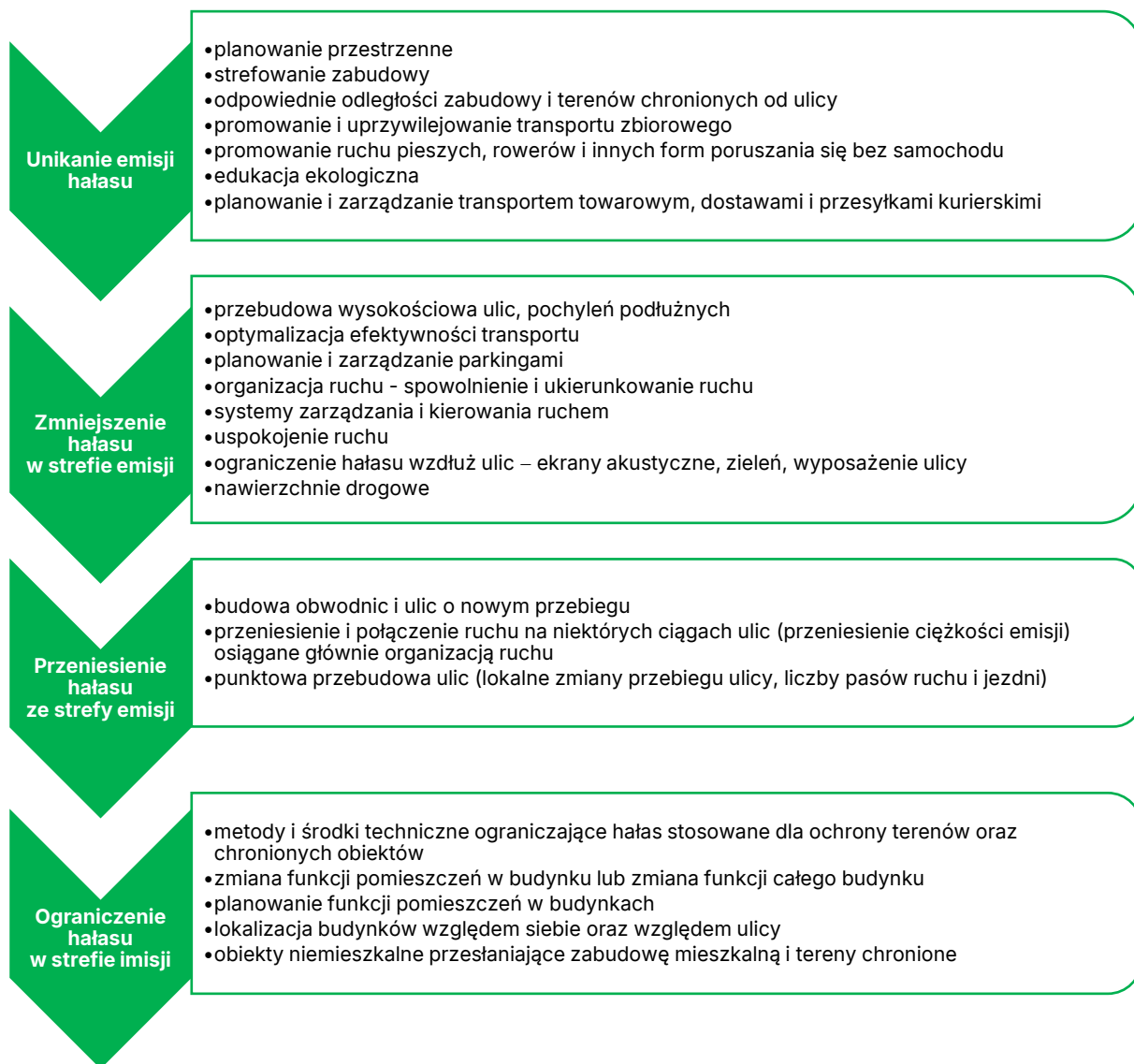
Rys. 11.4.1.2. Schemat zalecanego prowadzenia analizy związanej z doborem rozwiązań chroniących przed hałasem drogowym
