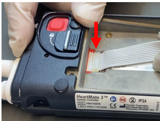
Ilustracja 1: Podłączenie kabla taśmowego baterii zapasowej
