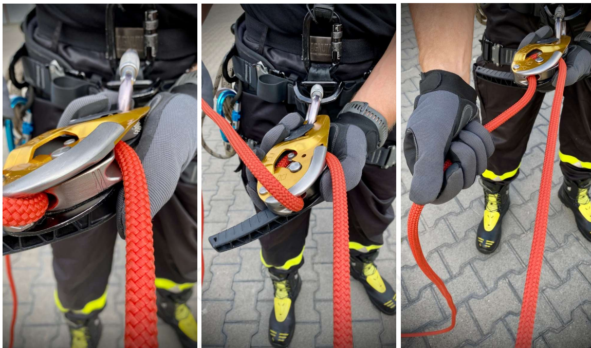
Fot. 63 Sposób obsługi przyrządu Petzl I'D S >2017 podczas asekuracji/wydawania liny.
