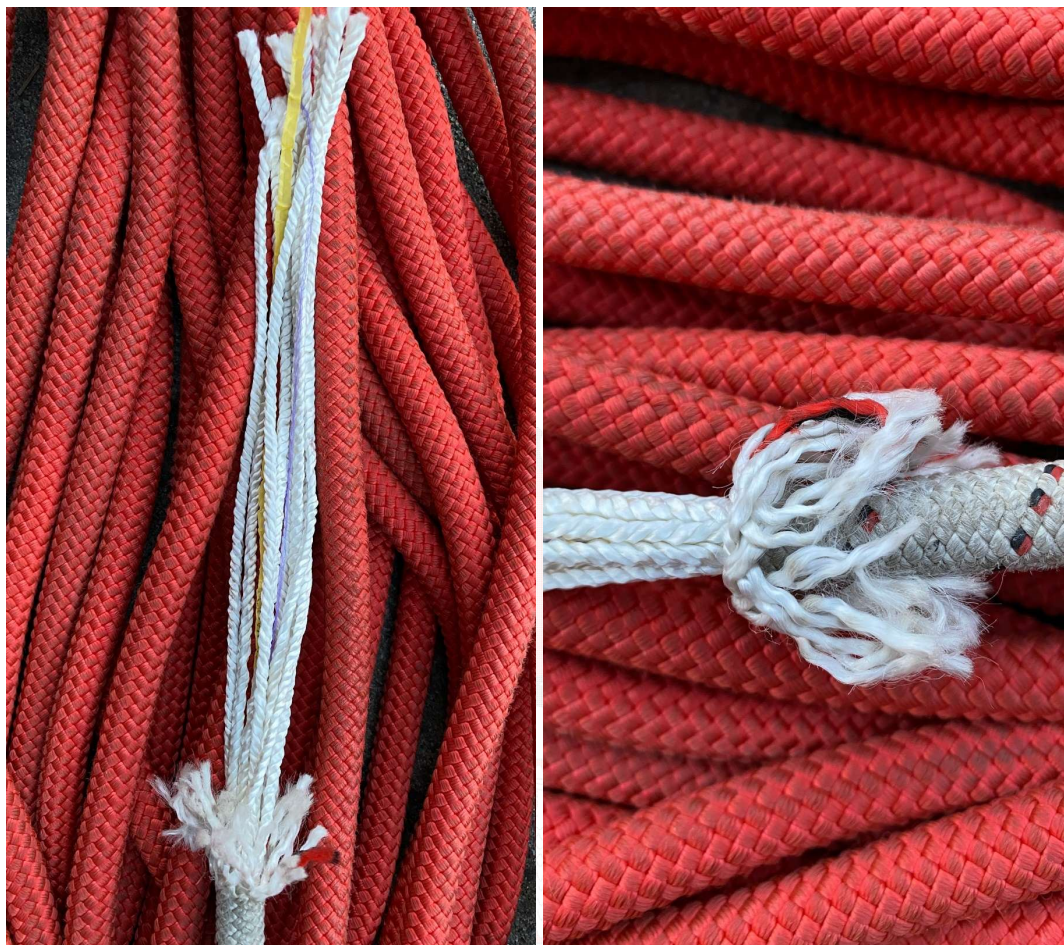
Fot. 13 Budowa liny półstatycznej.
