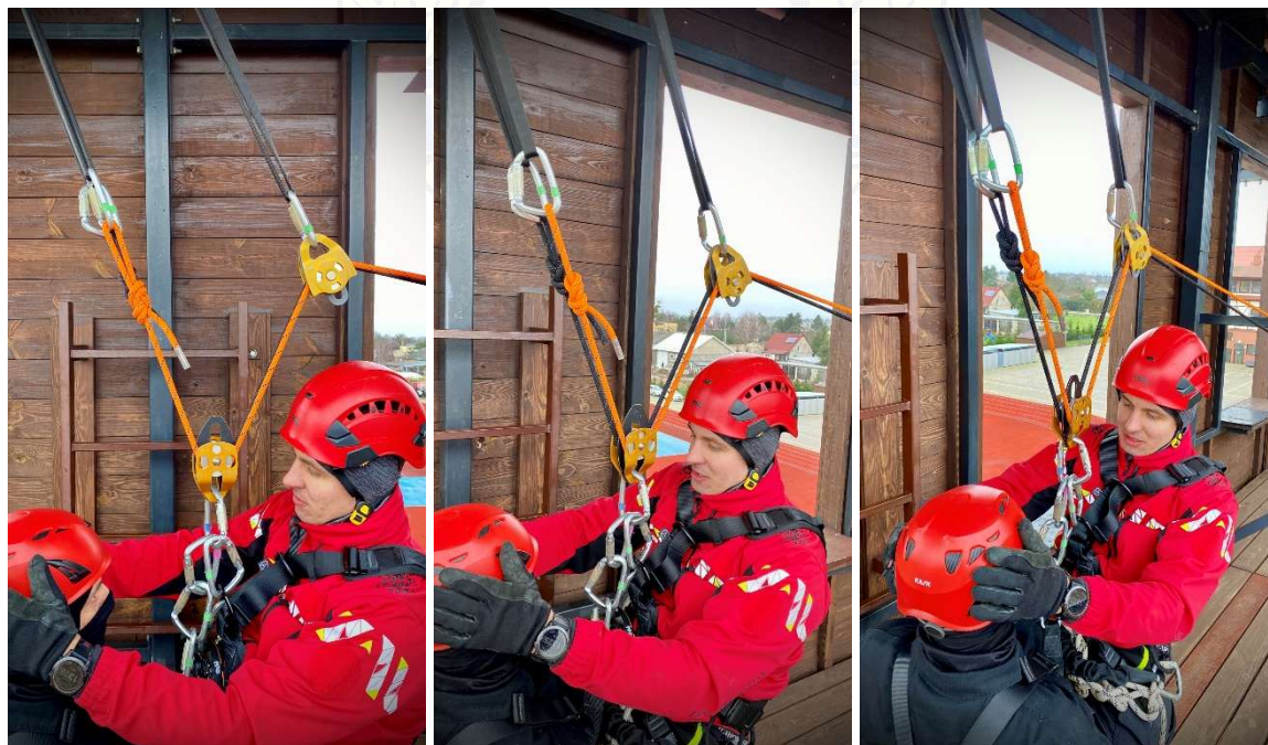
Fot. 126 Ewakuacja w układzie 2:1 (alternatywny).
