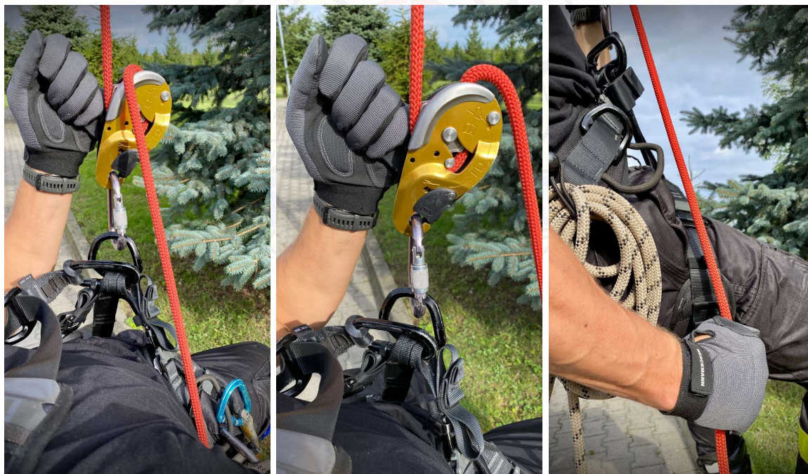
Fot. 66 Obsługa przyrządu Petzl I'D S podczas zjazdu.
