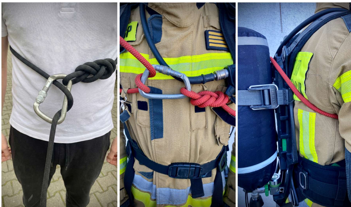
Fot. 72 Sposób wykorzystania pętli z liny.
