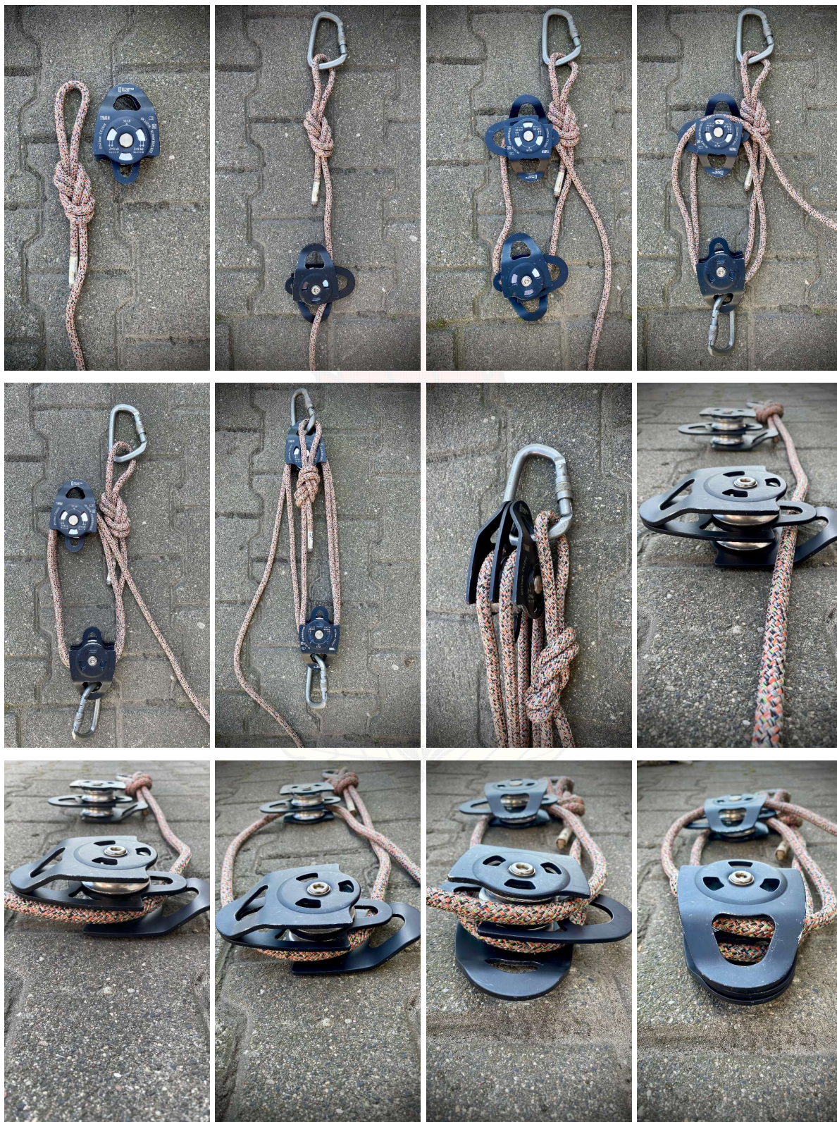
Fot. 145 Budowa układu 4:1
