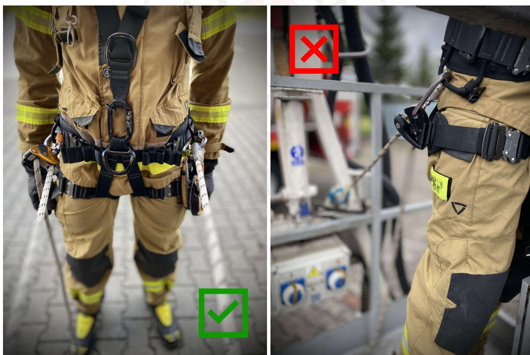
Fot. 9 Poprawne i błędne wykorzystywanie punktów bocznych w uprząży.
