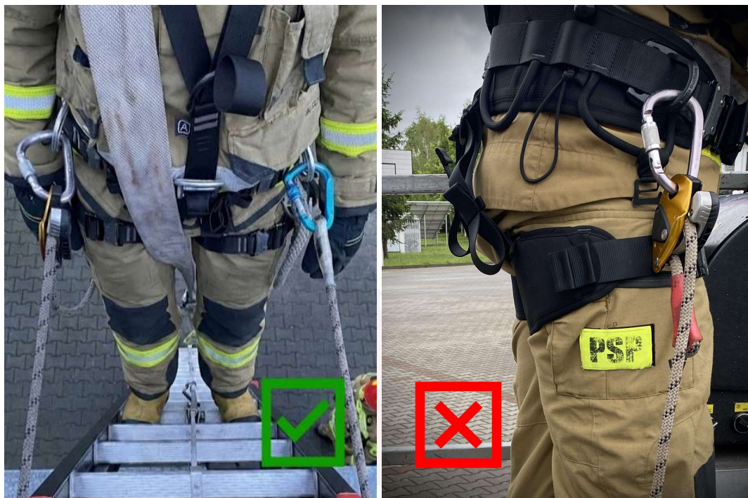
Fot. 8 Poprawne i błędne wykorzystywanie punktów bocznych w uprząży.
