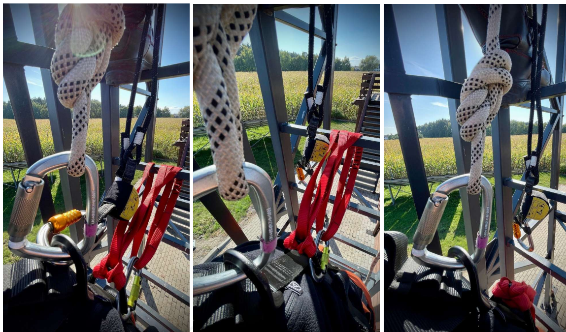
Fot. 115 Uwalnianie poszkodowanego z lonży i taśmy w układzie 1:1 ze zmianą kierunku.
