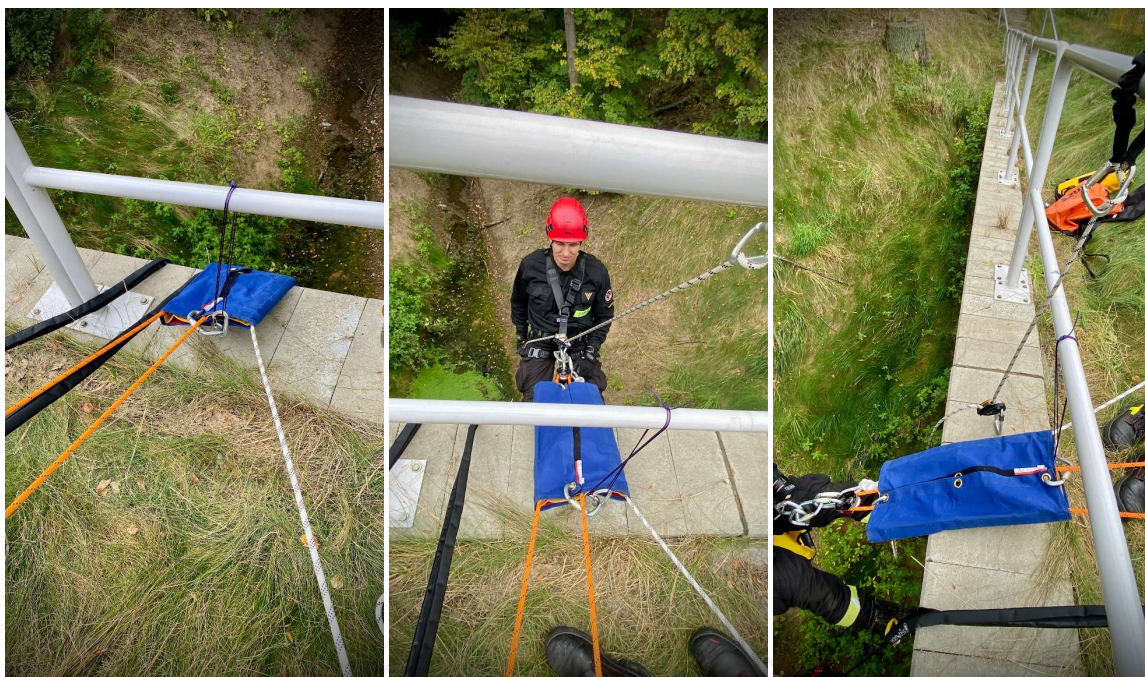
Fot. 128 Wyjście ratownika w ekspozycję w układzie 2:1 przez krawędź.
