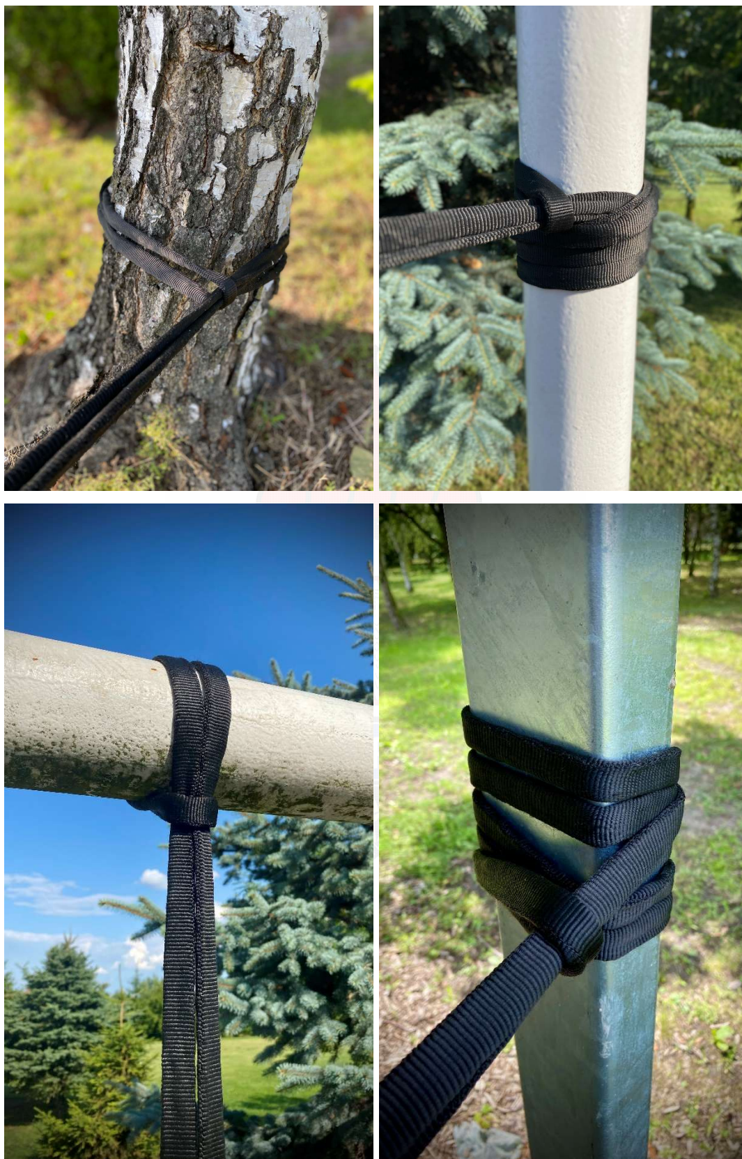
Fot. 25 Przykład wykorzystania taśmy jako stanowisko (EN 795 B).
