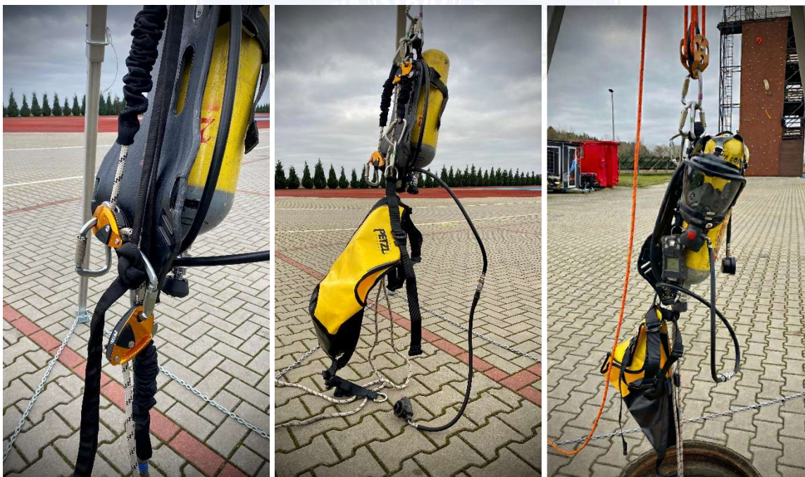
Fot. 150 Montaż zestawu do ewakuacji ze studni.
