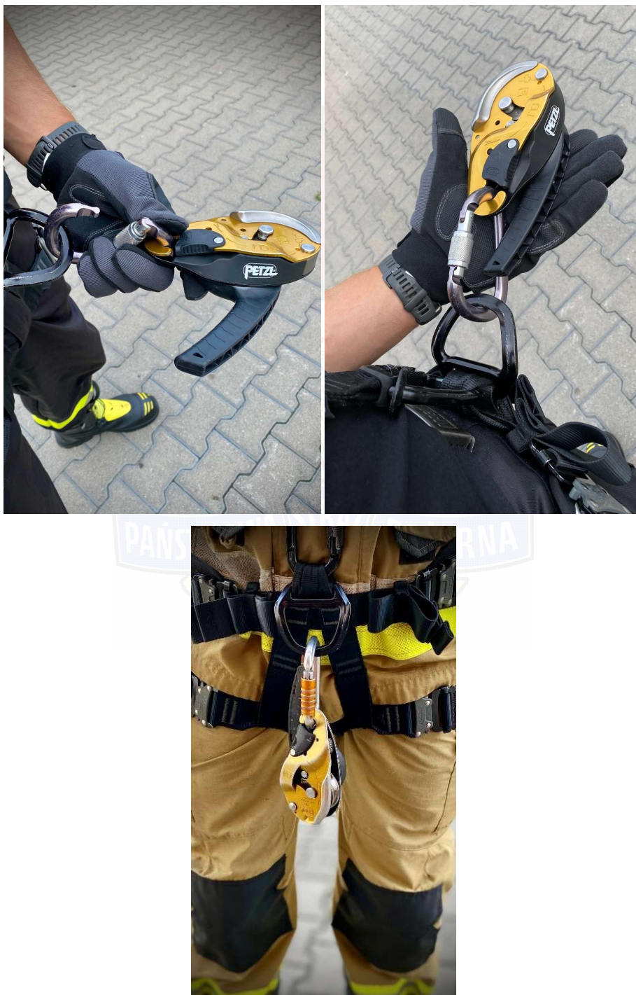
Fot. 60 Wpięcie przyrządu zjazdowego do uprząży.
