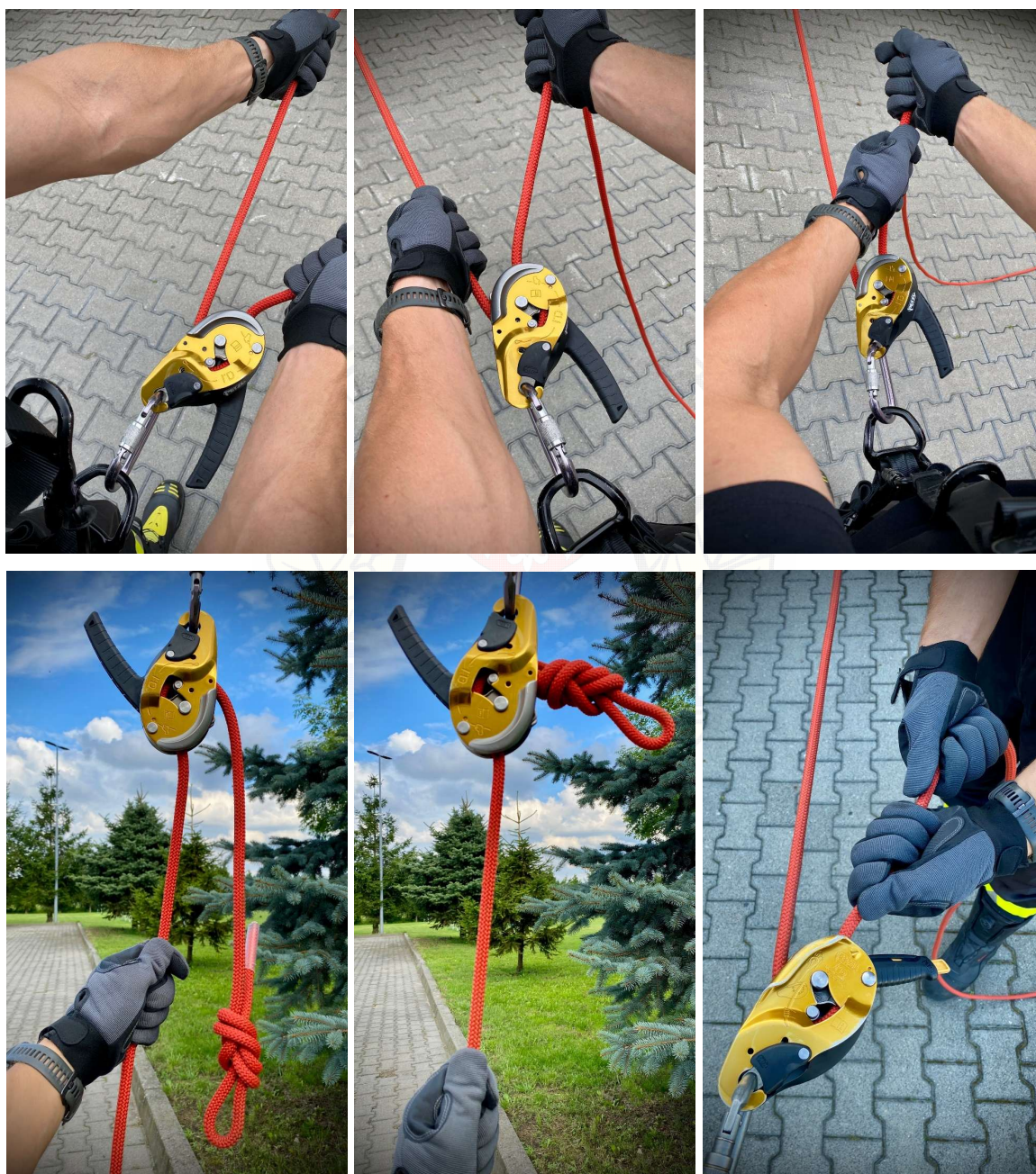
Fot. 65 Obsługa przyrządu zjazdowego Petzl I'D S podczas wybierania luźnej liny.
