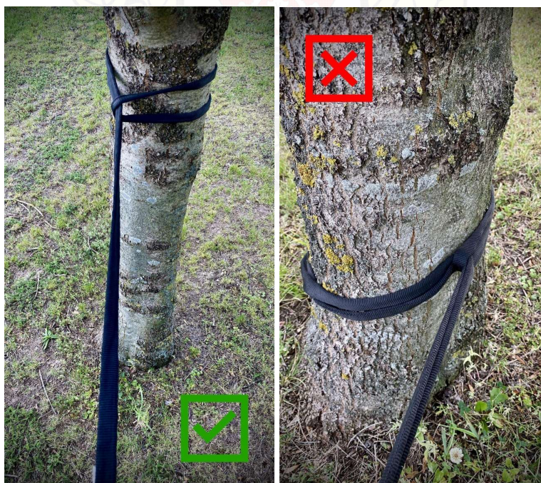
Fot. 58 Poprawność i błędy ułożenia taśmy stanowiskowej.
