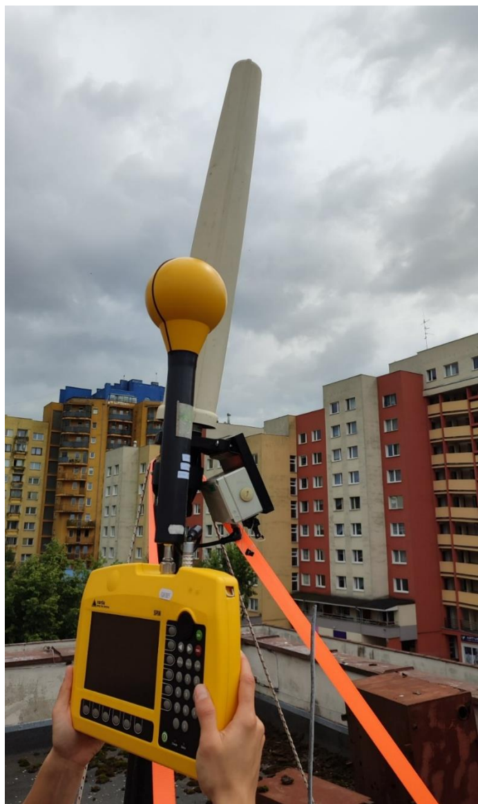
Rys. 8 Szkoła Podstawowa nr 118 – pomiary selektywne SRM-3600
