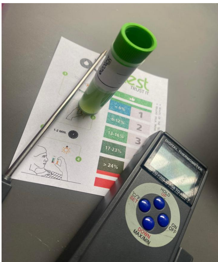
Fot. Oleotest wykonany w trakcie kontroli jakości zdrowotnej tłuszczu smaźalnycznych (źródło: zasoby własne PSSE w Rzeszowie)
