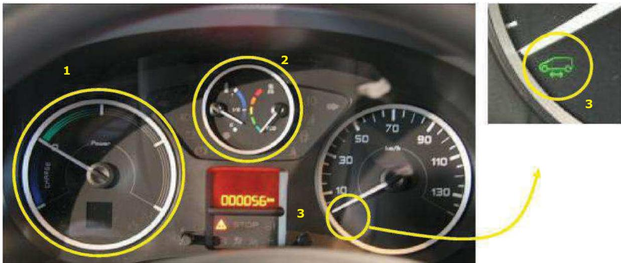
1. *Leistungsanzeige:* Zeigt die von den Antriebsbatterien abgegebene oder zurückgeführte Leistung an.
