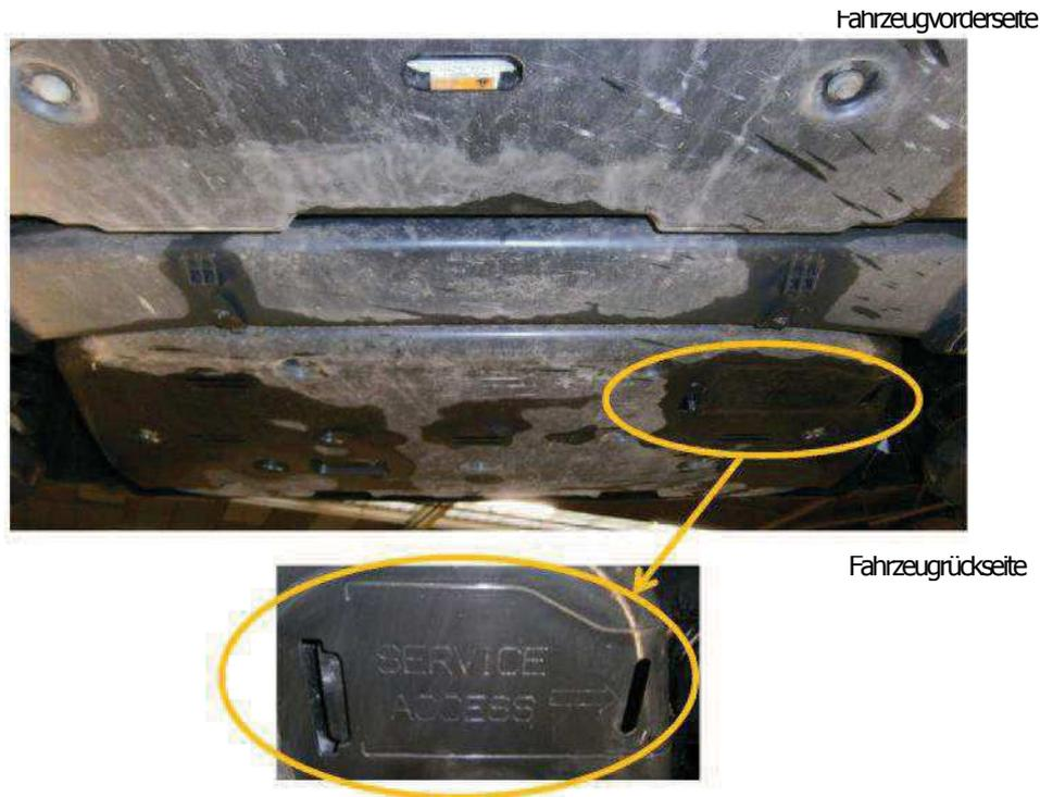
Anschließend muss der unten dargestellte Stecker abgezogen werden, um die Batteriepakete voneinander zu trennen:
