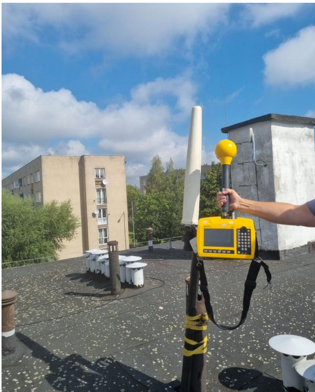
Rys. 9 Przychodnia Lekarska w Suwałkach – pomiary selektywne SRM-3600
